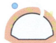
Embung bertanggul dengan Sumber Mata Air yang berada di luar tubuh embung
