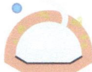
Embung tidak bertanggul dengan Sumber Mata Air yang berada di luar tubuh embung
