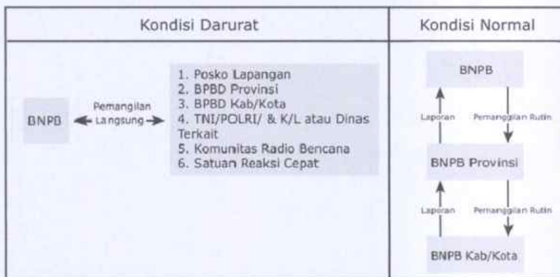
Gambar 6.1. Mekanisme Komunikasi Radio Pada Saat Tanggap Darurat dan Normal.
