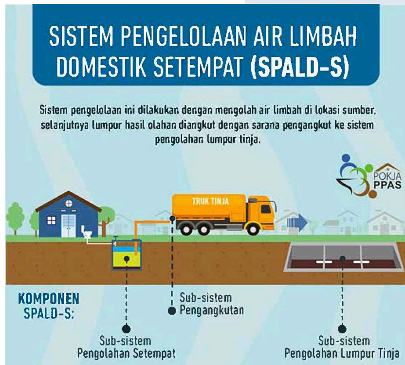
Gambar 3. 2 Pengelolaan Air Limbah Setempat (Sumber : Pasal 9 dan Lampiran I Prmen PUPR No. 4 Tahun 2017)
