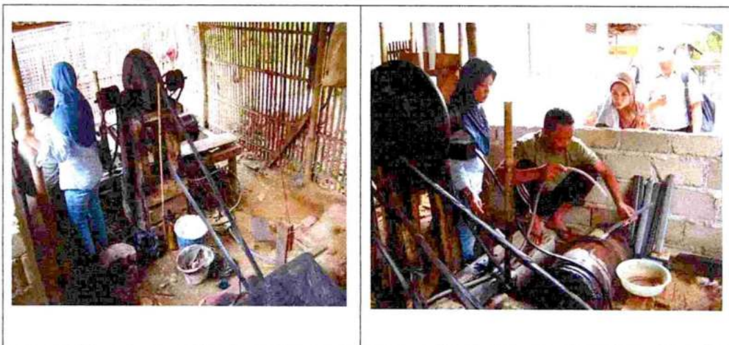
Gambar 2.3 Alat gelondong pengolahan amalgam emas digerakkan tenaga listrik
