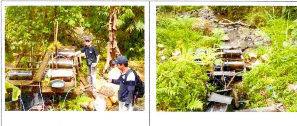
Gambar 2.2 Alat gelondong pengolahan amalgam emas digerakkan tenaga air
