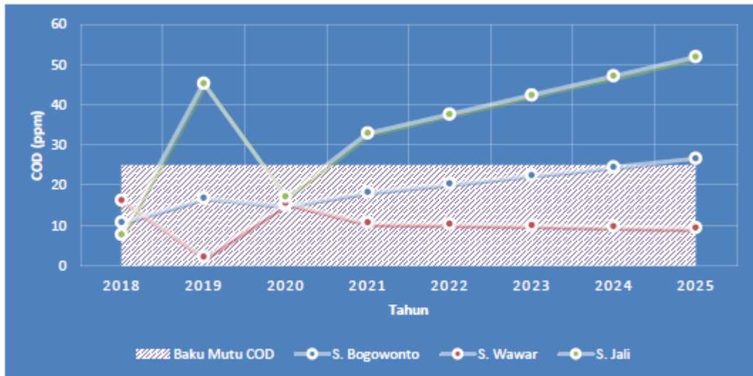
Gambar 3. 9. Proyeksi Nilai COD Sungai Bogowonto, Sungai Wawar, dan Sungai Jali Tahun 2018-2025 (Sumber: KLHS RPJMD Kabupaten Purworejo Tahun 2021-2026)
