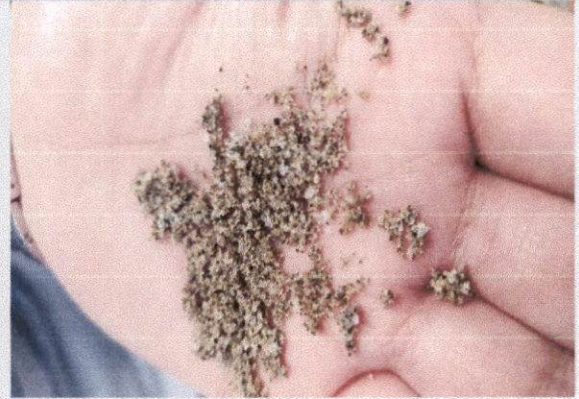
Pasir Kwarsa yang di bawa banjir, mengandung kerikil tajam yang merusak pipa dan mengalami kebocoran
