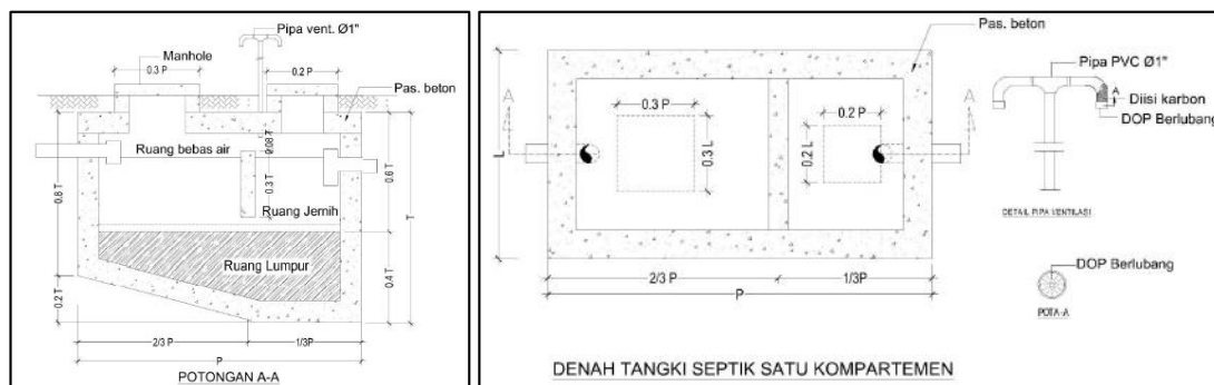
Gambar 3. 21 Ilustrasi Bentuk Tangki Septik sesuai SNI
