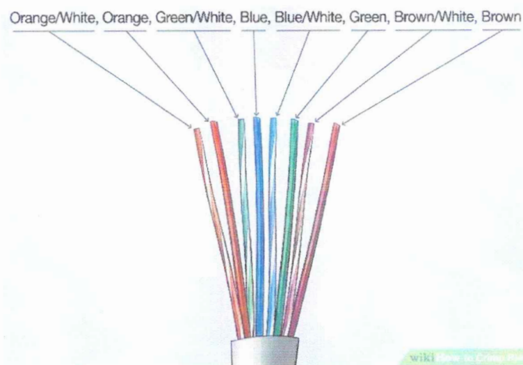
Gambar 23. Urutan kabel UTP
