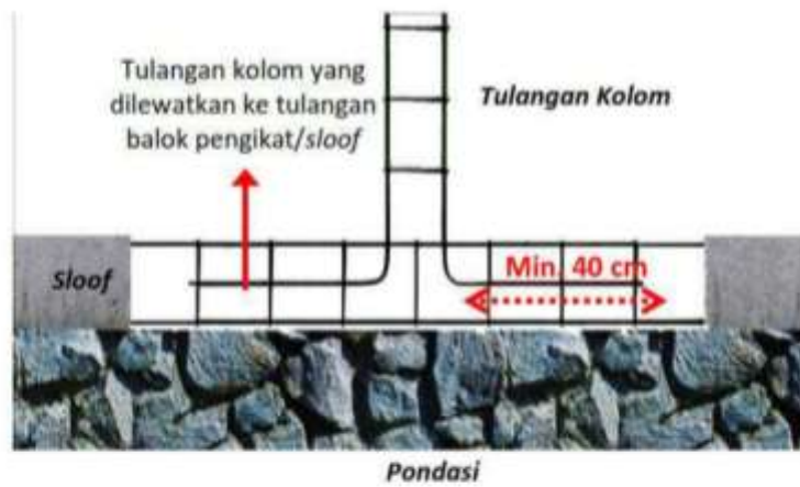
Gambar II.404 Detail Hubungan Balok Pengikat/Sloof dengan Kolom
