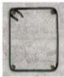
Tebal selimut beton 1 cm
