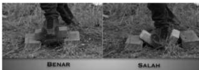
Gambar II.372 Pengujian Sederhana Kekuatan Batu Bata
