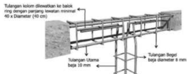
Gambar II.407 Hubungan Anatar Kolom dengan Balok Keliling/ Ring
