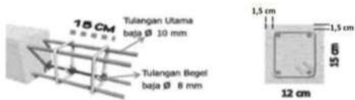
Gambar II.380 Dimensi Tulangan Balok Keliling/ Ring
