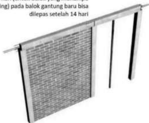
Gambar II.421 Pelepasan Cetakan/ Bekisting
