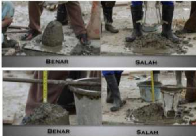
Gambar II.363 Pengujian Sederhana Dengan Menggunakan Cetakan dan Mengukur Selisih Ketinggian dengan Cetakan
