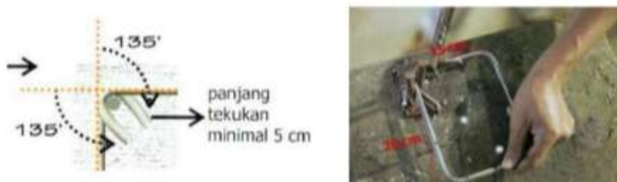
Gambar II.382 Tekukan Ujung Tulangan Begel
