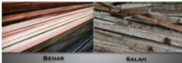
Gambar II.375 Kayu Yang Baik Digunakan Dalam Pembangunan
